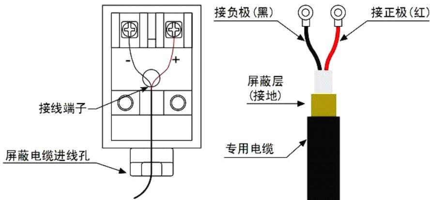
2、密封防水，接好线后必须用密封胶（耦合剂）注满，盖好盖后，必须将传感器屏蔽线缆进线孔拧好锁紧，以防进水；
