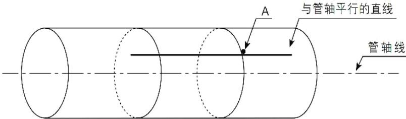
四、从 A 点开始，沿着定位纸边缘量出管道 1/2 周长，该平行交叉点为 C，在 C 点划一条与管轴平行的直线（也就是与定位纸上的直线平行）；
