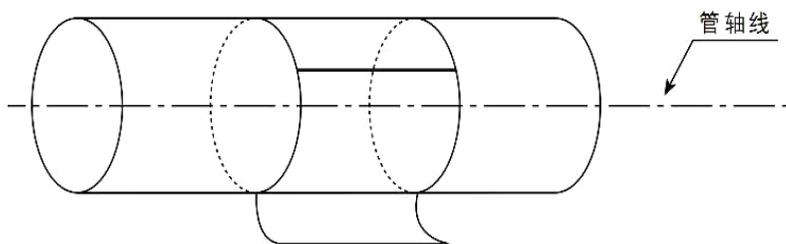
三、延长定位纸上的直线在管道上划一直线，所划直线与定位纸一边缘相交点为 A；
