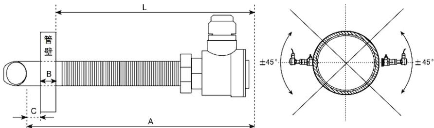
接线完毕后，锁紧进线螺母（注意密封垫不要丢失），最后拧紧密封盖，防止漏水。
