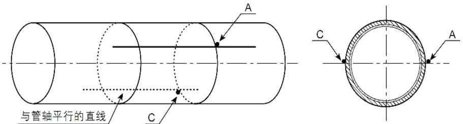
五、去掉定位纸，从 C 点开始，在所划直线上量出安装距离 L，从而决定 B 点。这样 A、B 两点为安装位置；例如  $L=280\text{mm}$ ，将球阀底座分别焊接在 A 和 B 两点上，注意球阀座中心点一定要分别于 A 和 B 两点重合。
