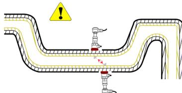
5、两个传感器必须安装在管道周面的水平方向上，并且在轴线水平位置  $\pm 45^\circ$  范围内安装，以防止上部有不满管、气泡或下部有沉淀等现象影响传感器正常测量。如果受安装地点空间的限制而不能水平对称安装时，可在保证管内上部分无气泡的条件下，垂直或有倾角地安装传感器。
