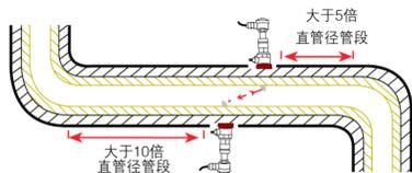
3、避免安装在管道系统的最高点或带有自由出口的竖直管道上（流体向下流动）
