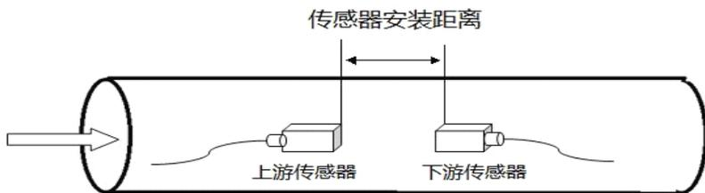
DN300以下V法安装示意，大口径使用Z法安装
