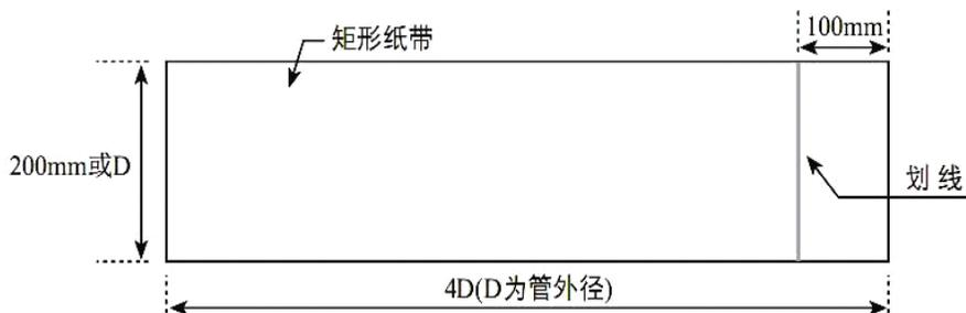
二、将定位纸缠绕在表面已清理干净的管道上，注意必须把纸两边互相重合对齐，才能使所划的线与管轴相平行；
